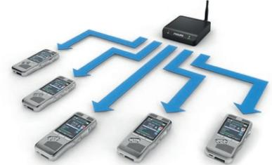
Stellen Sie automatische Firmware-Updates für Diktiergeräte der PocketMemo-Serie bereit. Die Firmware wird automatisch aktualisiert, wenn Sie das Diktiergerät an den WLAN-Adapter anschließen.
